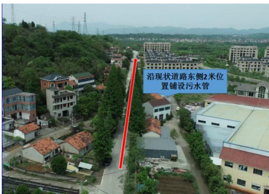
图 1-9 沿现状道路东侧 2 米位置铺设污水管（2）
