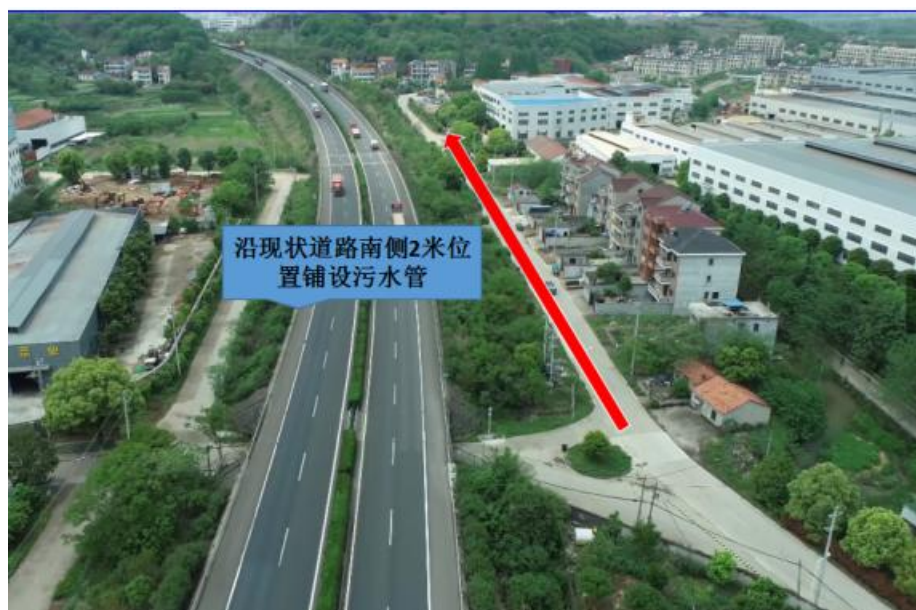
图 1-9 沿现状道路南侧 2 米位置铺设污水管（1）
