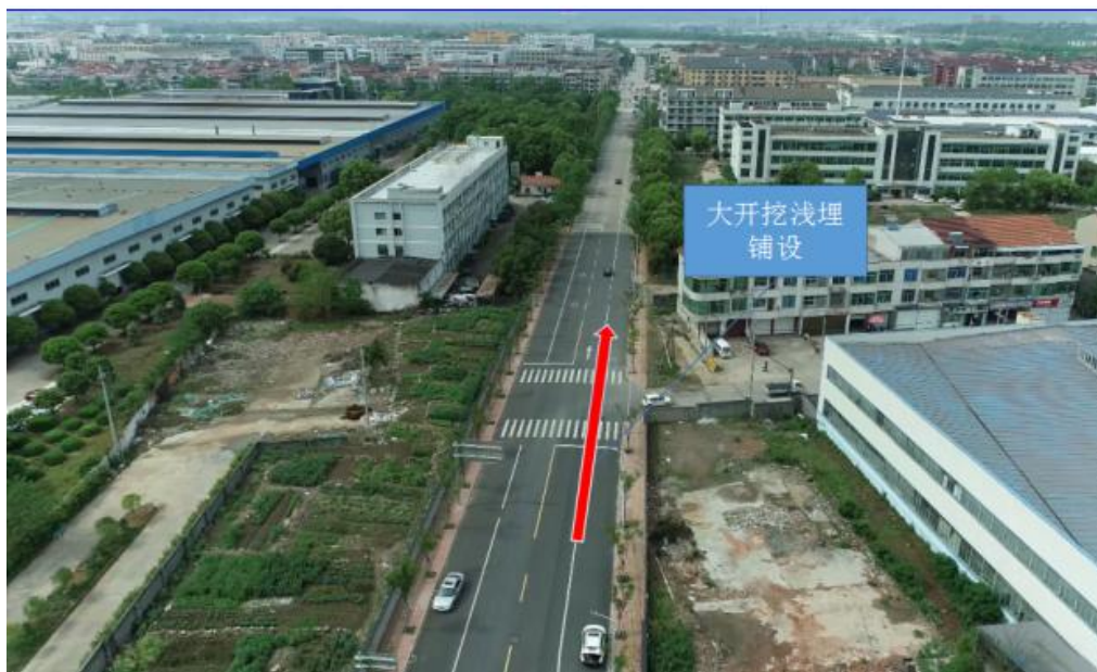
图 1-16 污水管沿经环东路铺设段，管线铺设于道路东侧车行道内
