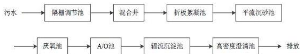
图 4.3-1 二期工程污水处理工艺流程图
